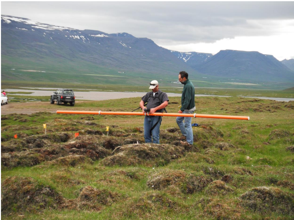
Obr. 54: Ukázka terénního měření s konduktometrem CMD Explorer (zdroj: http://blogs.umb.edu/sass/ ).
