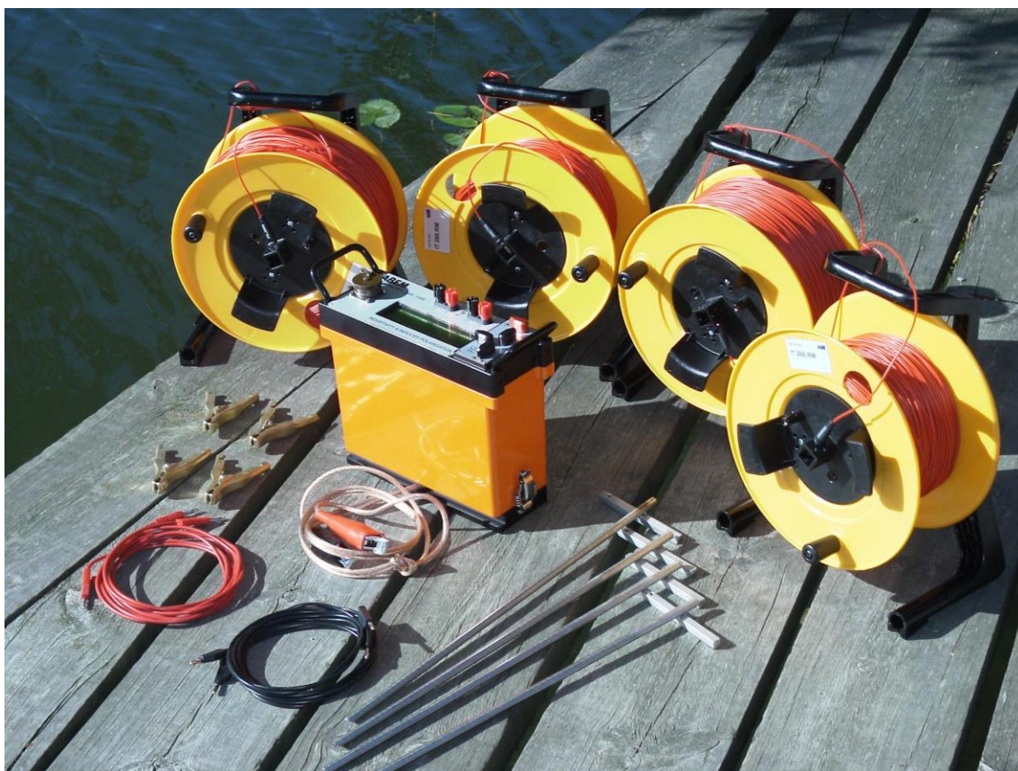
Obr. 56: Odporová aparatura SAS 1000 (zdroj: ABEM Instrument, Švédsko, 2011).
