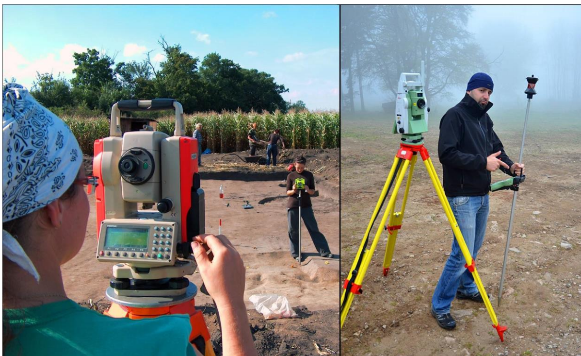
Obr. 16: Vlevo – ukázka práce s dvoumužnou totální stanicí Pentax V-325N. Vpravo – příklad jednomužné robotické totální stanice Leica Viva TS15 s controllerem CS15 a 360° hranolem (foto: M. Vágner).
