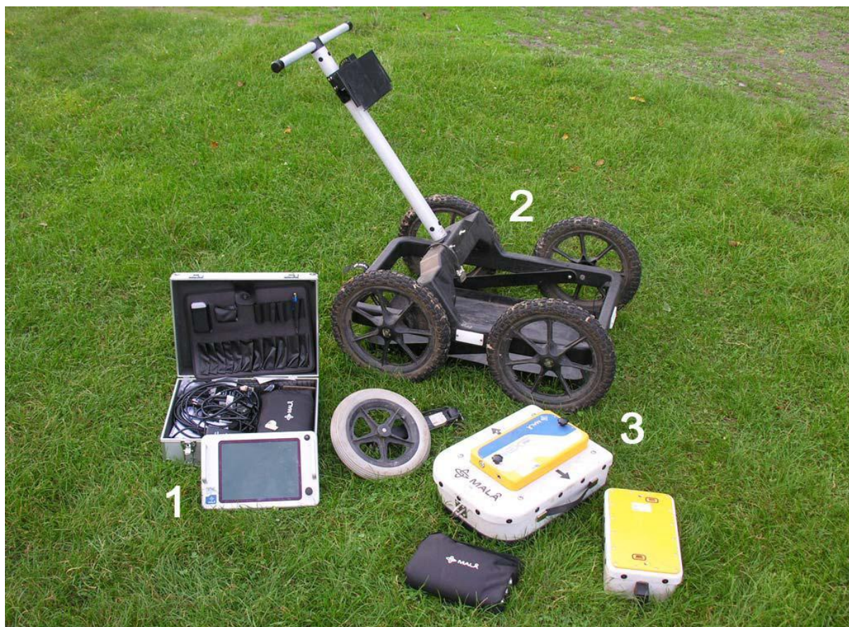
Obr. 52: Ukázka GPR techniky od švédské společnosti GEOSCIENCE MALÅ: 1 – konzole pro vizualizaci a předběžnou práci s naměřenými daty; 2 – vozík na umístění antény; 3 – GPR antény (vlevo anténa o frekvenci 500 MHz s připojenou centrální jednotkou, vpravo anténa o frekvenci 800 MHz; autor fotografie: M. Vágner).
