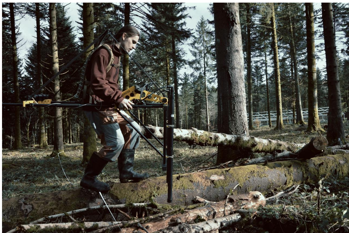
Obr. 60: Ukázka terénního měření s fluxgate magnetometrem Förster Ferex od německé společnosti Dr. Förster Reutlingen (foto: M. Vágner).
