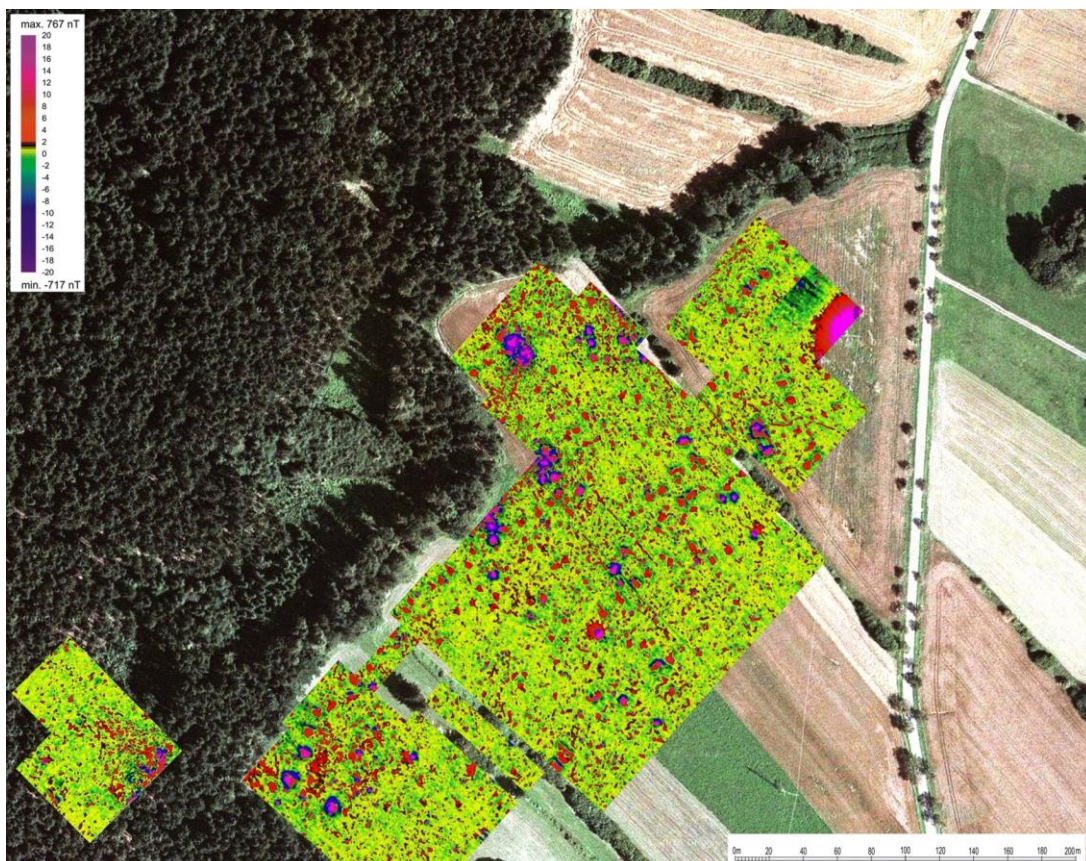
obr. 41. Zaniklé středověké důlní středisko jižně od Vyskytné na Pelhřimovsku. Geomagneticky zjištěné podpovrchové struktury interpretované jako sídlištní a další archeologické objekty. V areálu jsou patrné výrazné geomagnetické anomálie, považované za indikátory někdejších metalurgických pracovišť. Měření ÚAM FF MU Brno a ARCHAIA Brno (P. Milo, J. Zeman, P. Hrubý).
