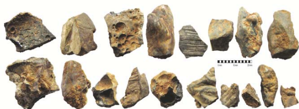
▲ Obr. 73 Hutnický areál ze 13. století u Černova na Pelhřimovsku. Detail hutnických strusek, které prošly stoupaním a mletím nejspíš proto, aby mohly být znovu použity do vsázky při dalších tavbách. Foto Petr Hrubý.
